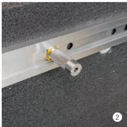
Fissare la dima di perforazione 0° diritta, gialla, con un quarto di giro nella clip per angolo in alluminio Vento.
